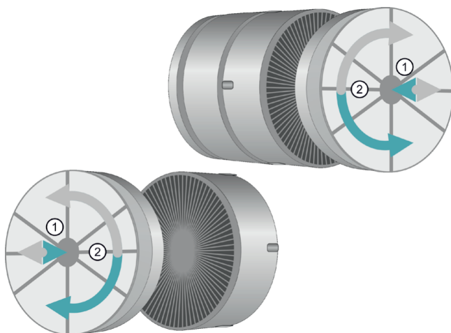
Рис. 14 Установка угольного фильтра
