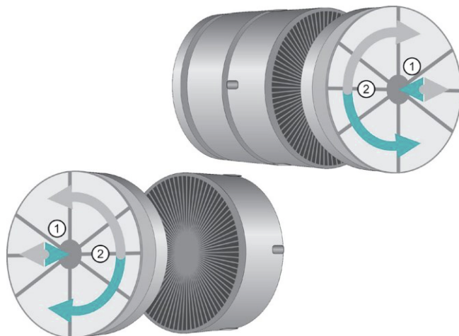
Fig. 14 Instalación del filtro de carbono
