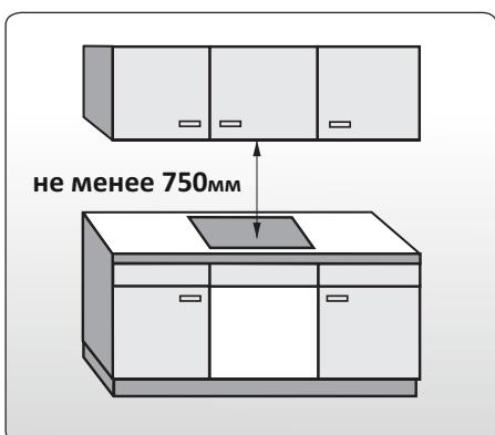
• Необходимо соблюдать указанное производителем вытяжки безопасное расстояние между панелью конфорок и расположенной сверху вытяжкой. Если указания производителя вытяжки отсутствуют или над прибором монтируются навесные полки из легко воспламеняющихся материалов, то необходимо соблюдать безопасное расстояние минимум 750 мм.
