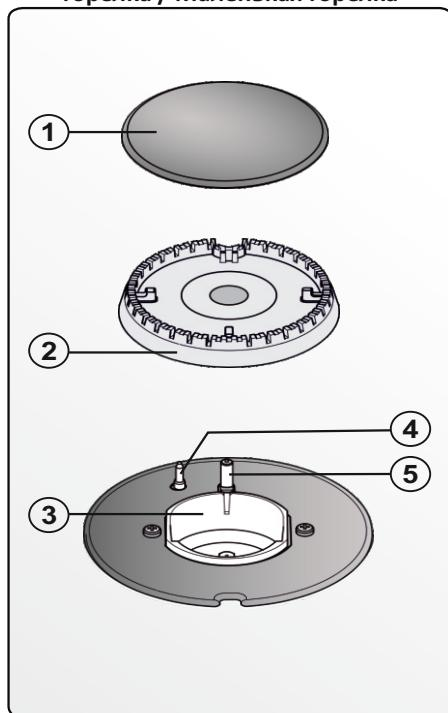
1. Крышка горелки, 2. Смеситель, 3. Основание горелки, 4. Термоэлемент, 5. Электроподжиг
