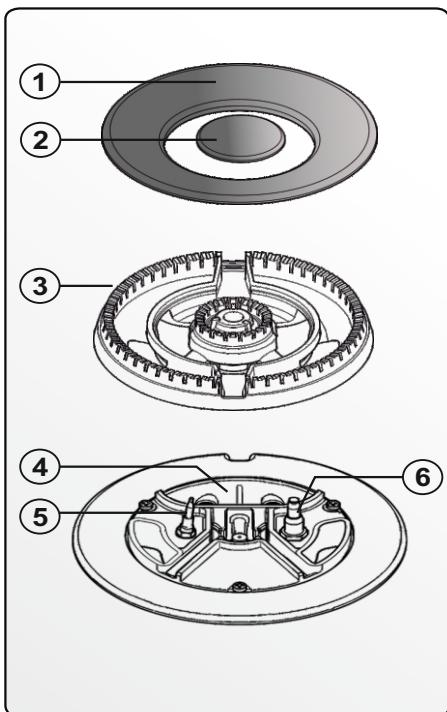
1. Крышка горелки внешняя, 2. Крышка горелки внутренняя, 3. Смеситель, 4. Основание горелки
