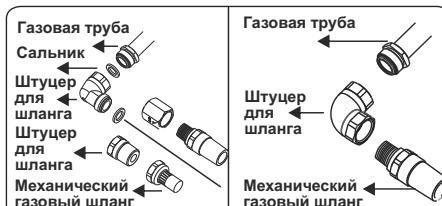
**ВНИМАНИЕ!** При подсоединении прибора к газовой сети гибким токопроводящим шлангом (стальным или в стальной оплётке и т.п.) следует применять специальную изолирующую вставку. Вставка устанавливается на внутридомовом газопроводе после крана.
