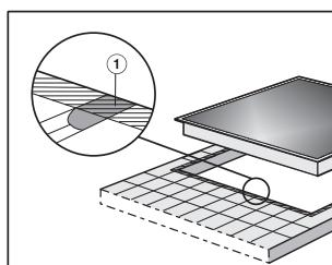
Стыки и заштрихованная область под поверхностью панели конфорок должны быть гладкими и ровными, чтобы панель лежала ровно и уплотнение под кромкой верхней части прибора обеспечивало герметизацию столешницы.
